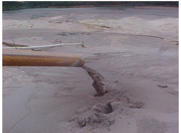
Lançamento de Rejeito
